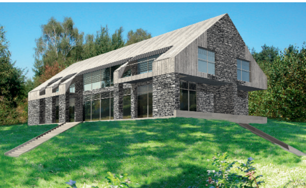
WIDOK ZE WZGÓRZA Masywny mur obłożony kamieniem łamanym warstwowo oraz betonem licowym kontrastuje z dużymi przeszkleniami. Zarówno strefa dzienna na parterze, jak i sypialnie na piętrze zostały zaplanowane tak, by cieszyć widokiem rozpościerającym się z okien
