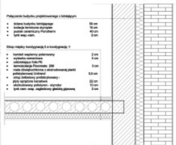
DETAL POŁĄCZENIA BUDYNKU PROJEKTOWANEGO Z ISTNIEJĄCYMI skala 1:2
