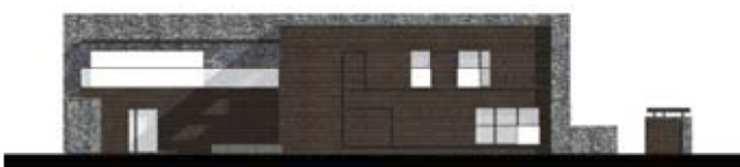
ELEWACJA OGRODOWA: TU NAJLEPIEJ WIDAĆ GRĘ DWÓCH MATERIAŁÓW – CIEPŁEGO GONTU I ASCETYCZNEGO KAMIENIA
